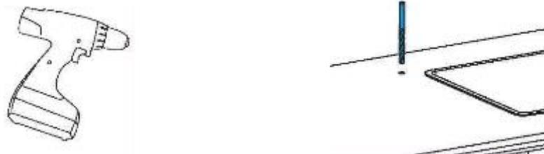
Introduzca la rosca del grifo junto al aro embellecedor cromado y la junta de estanqueidad por la parte superior de la encimera o pica de acero.
