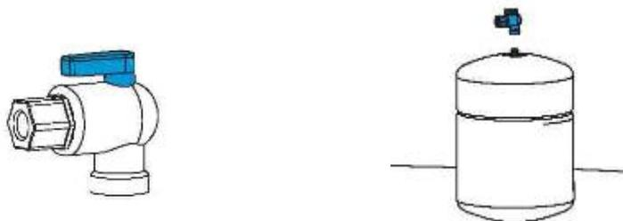
Para asegurar la estanqueidad, utilice teflón de rollo ( no de hilo) para la rosca de depósito y ajústelo con la mano sin sobrepasarse. Posteriormente, conecte otra tubería que una el depósito con el otro extremo del post filtro (TANK).
