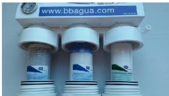
Lo mismo realizaremos con la membrana, para ello, hay que desenroscar la tapa del contenedor. Retirar la membrana de su embalaje ( Bolsa ) y colocarla dentro del contenedor. Asegurarnos que el extremo de las dos juntas vaya al final, y presionando suavemente.
